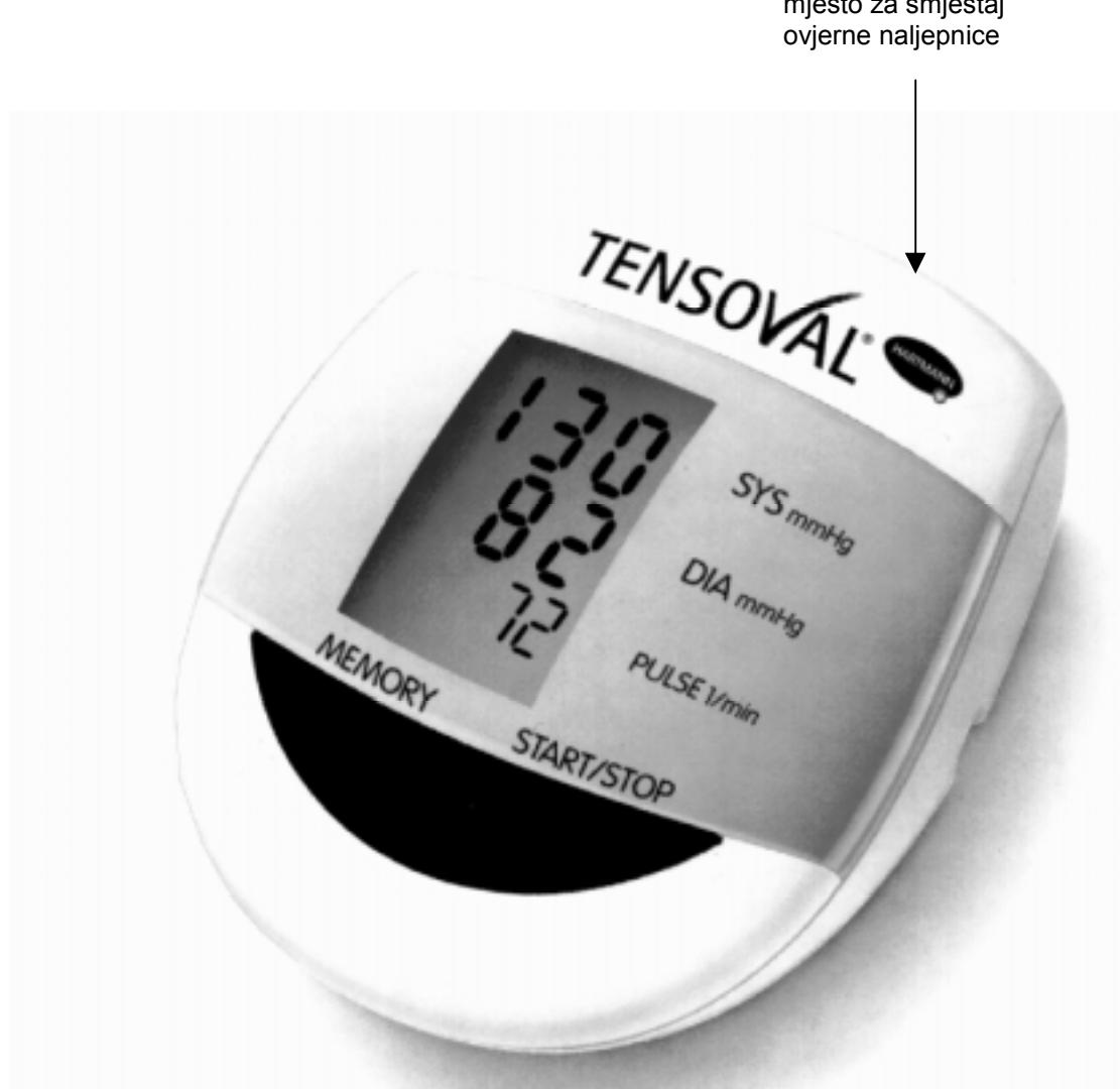
Slika 1: Izgled tlakomjera tip Tensoval Comfort s prikazom mjesta za smještaj ovjerne naljepnice
